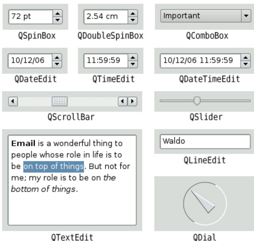
图 2.22: Qt 的输入窗口部件
